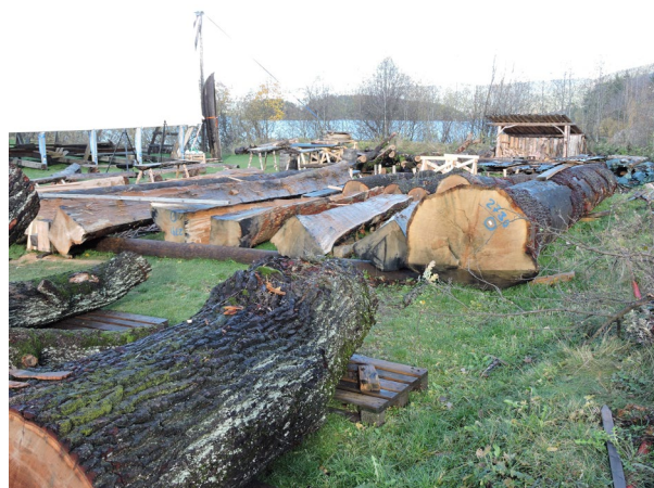
Eik fra Danmark skal bli skipsplank. Kløyving i hovedsak med håndmakt.
